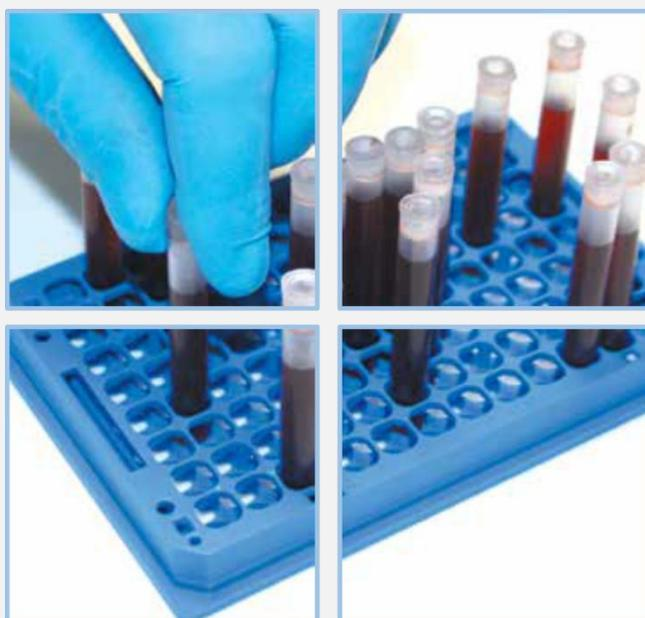
Une fois que les micropuits sont identifiés via les codes à barres gravés sur leur base, vous serez en mesure de séparer chaque micropuits individuellement et de créer une nouvelle plaque de stockage avec les micropuits extraits: La plaque 3S d'accueil.
